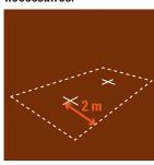
2 Creusez la tranchée ou la fosse jusqu'à une profondeur correspondant à la largeur de votre rouleau, au minimum de 70 cm. Stocker la terre sur le bord.
