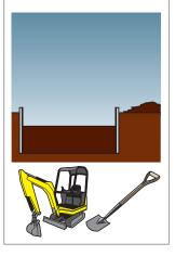
5 Plantez votre plante et remplissez avec de la terre en laissant apparent 2 cm de Bamboo Stop Pro au-dessus de la surface.
