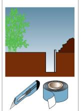
Remplissez avec de la terre en laissant apparent 2 cm de Bamboo Stop Pro au-dessus de la surface.
